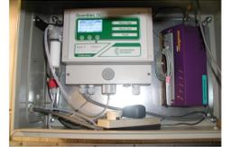
Appareil de mesure (Guardian®) permettant les mesures de méthane au niveau du distributeur automatique de concentrés
